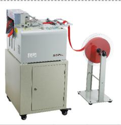
高速:每分钟可切断 80~100 片。(以 50mm 长度为例) 高精度:每一次切断都由步进电机监控,以保证每次操作的
