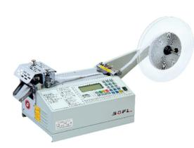
高速:每分钟可切断 100 片左右。(以 50mm 长度为例) 高精度:每一次切断都由步进电机监控,以保证每次操作的高精
